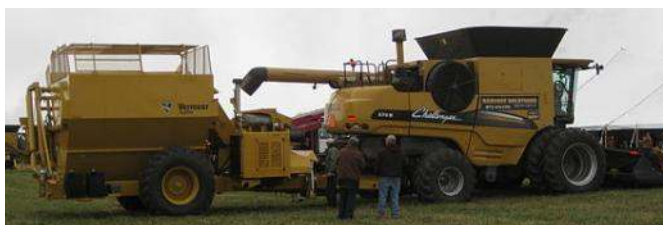
Figure 3 : Le collecteur de rafles Vermeer peut contenir jusqu'à 4t de rafles, photo RMT Biomasse.
