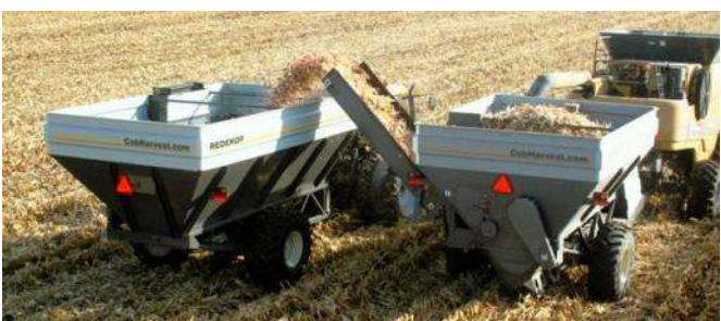
Figure 4 : Le collecteur de résidus Redekop vidangeant directement au champ.
