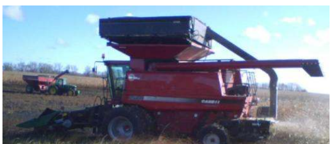
Figure 5 : Le système Top Tank développé par Case collecte rafles et spathes.
